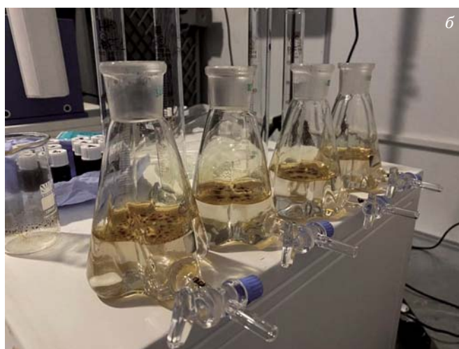
Рис. 5. Фотографии испытательных емкостей после проведения контрольных экспериментов с применением рассматриваемых методик: a — SFT-тест; b — BFT-тест
