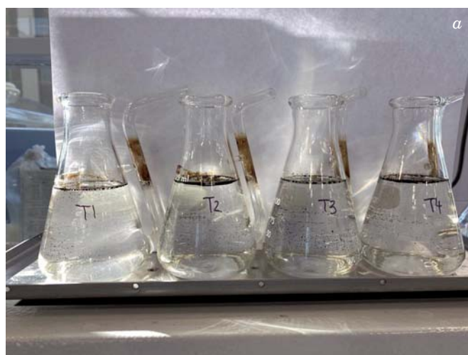
Рис. 5. Фотографии испытательных емкостей после проведения контрольных экспериментов с применением рассматриваемых методик: a — SFT-тест; b — BFT-тест
